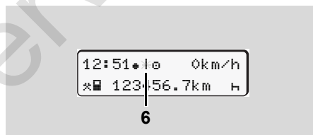
Standardindikering (a): Identifieringen av data-nedladdningen pågår
